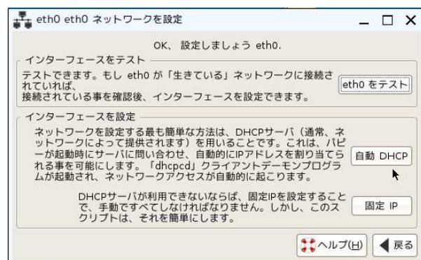
ネットワーク内に DHCP サーバが稼働している場合は「自動 DHCP」をクリックします。
